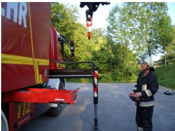
Nach dem ersten Teil nach der Mittagspause wurden die Gruppen getauscht, da der Kran auf dem GWL-2 außerdem noch über eine Seilwinde verfügt. So konnten beide Gruppen zum einen mit der Seilwinde am Kran des GWL-2, sowie auch mit dem am LKW des Bauhofs angebrachten "Rotator" mit Palettengabel arbeiten. Bei dieser Ausrüstungsvariante wird die Palettengabel über den "Rotator" fest
