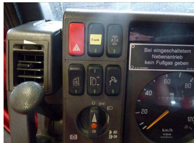
Auf der Armaturentafel wurde ein zusätzlicher Schalter für das Dauerhafte einschalten der Zusatzscheinwerfer Installiert.
